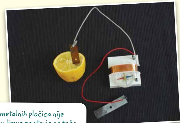
Jedna od metalnih pločica nije utaknuta u limun pa struja ne teče.
