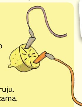
Kad su bakrena i pocinčana pločica u limunu, on radi kao slabašna baterija. Kompas u blizini zavojnice malo se rotira, što znači da kroz žicu teče struja.
